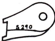
外胴の2つの穴へ治具(S-290)の突起を入れ板バネを押しピンを溝からはずす。この時治具を写真の矢印方向約45°ぐらいの角度にして押し外胴と内胴がはずれます。
