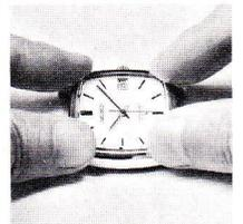
⑤内胴と外胴が完全に喰い付くように、更に写真のようにして指で強く押してください。
